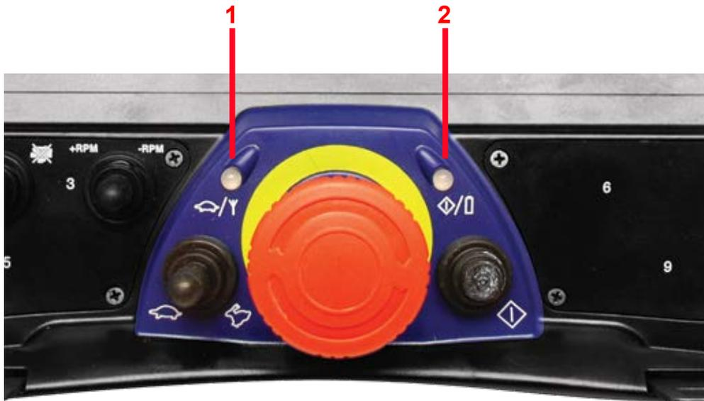
Abb. 6.1 Zustandsanzeigen und Alarmmeldungen auf der Fernbedienung.
