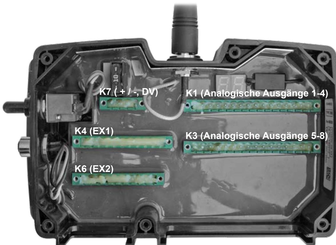
Abb. 3.9 Interne Verbindungsendpunkte der Zentraleinheit Standard Typ 2000 (Danfoss) und Typ 3000 (PWM).
