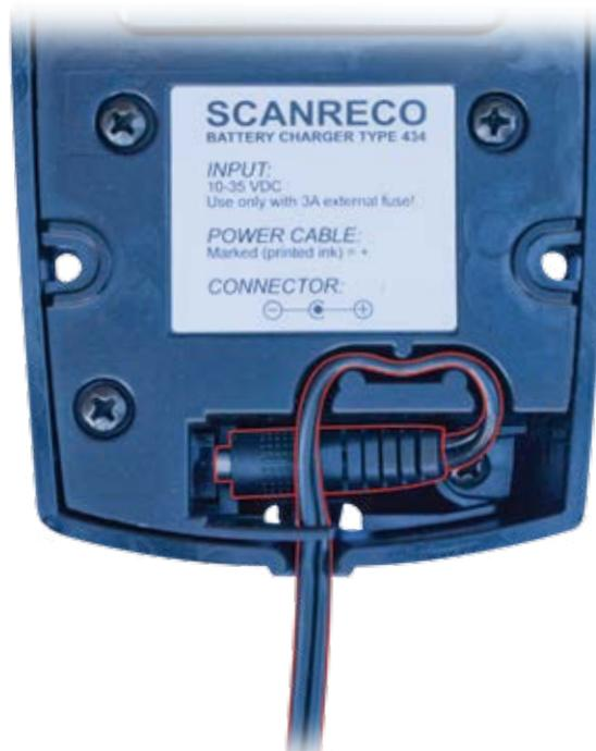
Abb. 3.13 Positionierung des Versorgungskabels des Batterieladegeräts.
